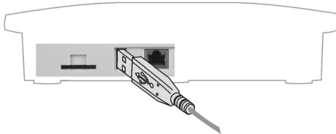
COMpact 3000 VoIP: Die Abbildung im Anschluss zeigt die Position der USB-Buchsen seitlich am Gehäuse.
