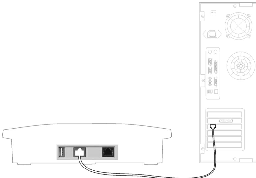
COMpact 3000 VoIP: Die Abbildung im Anschluss zeigt die Position der RJ-45-Buchsen „LAN“ seitlich am Gehäuse sowie die fertige Verbindung mit dem PC.
