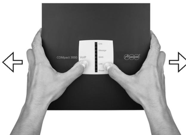
3. Heben Sie die Abdeckhaube senkrecht vom Gehäuse ab. Drücken Sie dazu unterstützend mit den Daumen gegen das Gehäuse.
