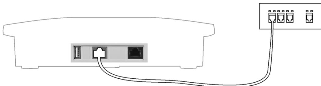
COMpact 3000 VoIP: Die Abbildung im Anschluss zeigt die Position der RJ-45-Buchse „WAN“ seitlich am Gehäuse sowie die fertige Verbindung.
