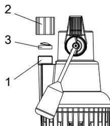
**Abb. 3:** Rückschlagklappe und Muffe montieren
