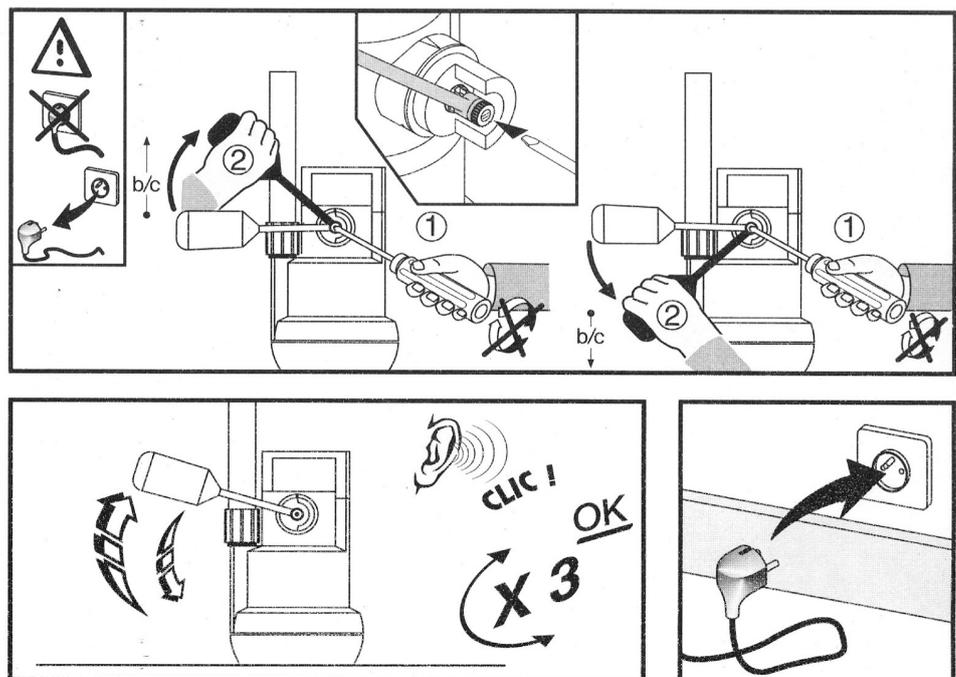
Abb. 5: Einschaltsteuerung einstellen
