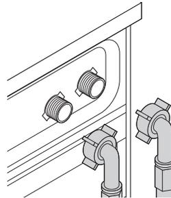
**!** Achten Sie bei der Installation Ihres Gerätes darauf, dass Kalt- und Warmwasseranschlüsse korrekt durchgeführt werden. Andernfalls kommt Ihre Wäsche am Ende des Waschvorgangs eventuell heiß aus der Maschine und verschleißt schneller.
