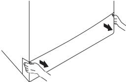
**i** Die Filterabdeckung lässt sich entfernen, indem Sie einen dünnen Gegenstand mit Kunststoffspitze zur Hand nehmen und die Abdeckung durch die Öffnung oberhalb der Filterabdeckung etwas nach unten drücken. Versuchen Sie nicht, die Abdeckung mit Metallgegenständen zu lösen.
