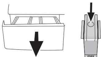
1. Drücken Sie die runde Markierung im Weichspülerfach hinab und ziehen Sie die Schublade zu sich hin, bis Sie sie aus der Maschine nehmen können.
