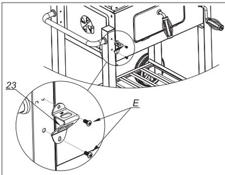
Hinweis: Falls die Bohrlöcher im Standbein nicht exakt mit den Bohrlöchern im Flaschenöffner übereinstimmen, setzen Sie zuerst eine Schraube locker ein. Drehen Sie anschließend die zweite Schraube ein und ziehen Sie dann beide Schrauben gleichmäßig an, bis der Flaschenöffner fest sitzt.
