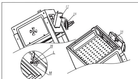
Hinweis: Das Schließblech (16) muss vertikal mit dem Türgriff der Holzkohletür (18) positioniert werden.
