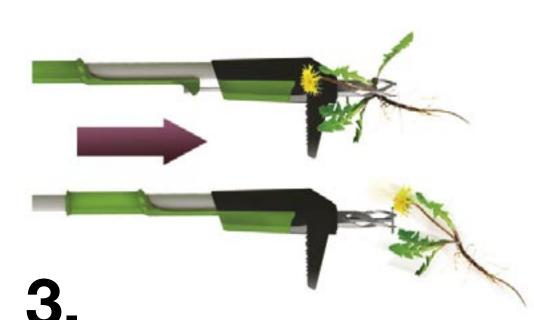
Durch Schieben des Handgriffs mit einem einzigen Stoß die Unkrautpflanze aus dem Gerät entfernen
