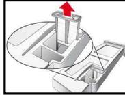
3. Filter unter fließendem Wasserstrahl oder in der Geschirrspülmaschine reinigen.
