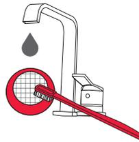
**2** Reinigen Sie die Gitter mehrmals unter fließendem Wasser.
