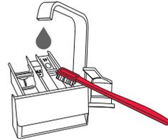
**2** Unter fließendem Wasser reinigen Sie das Dosiergefäß mit einer Bürste und trocknen Sie es. Beseitigen Sie auch die Waschmittelreste vom Boden des Gehäuses.
