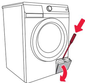
**1** Öffnen Sie die Filterabdeckung mit einem Werkzeug (Schraubenzieher oder ähnliches).
