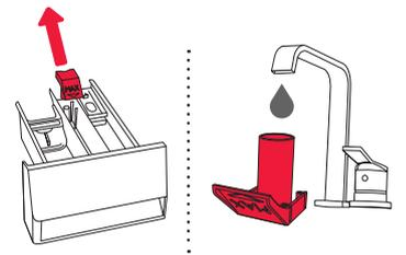
**3** Nach Bedarf entfernen und reinigen Sie auch den Deckel des Stoppels. Reinigen Sie diesen unter fließendem Wasser und setzen Sie ihn wieder auf.
