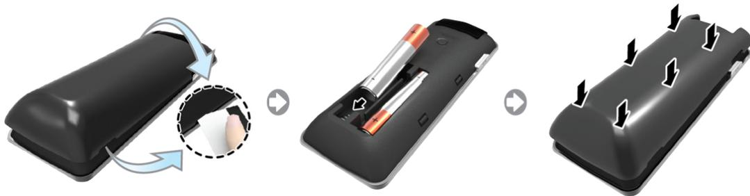
1. Heben Sie die Abdeckung des Batteriefachs mit Hilfe einer Kunststoffkarte ein wenig an. Ziehen Sie dann mit einem Fingernagel an der Kerbe der Batteriefachabdeckung, und entfernen Sie die Abdeckung vollständig.
