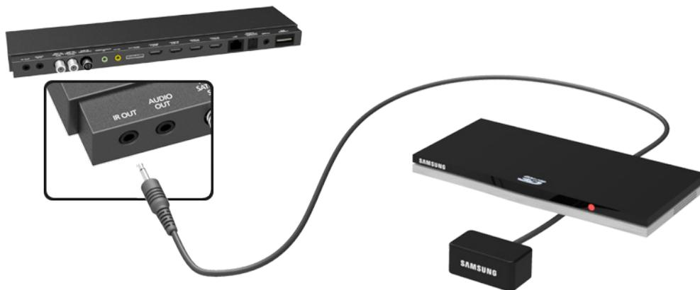
Verbinden Sie das eine Kabelende mit dem IR-Anschluss für One Connect, und richten Sie den Sender am anderen Ende des Kabels auf den Fernbedienungsempfänger des externen Geräts. Zwischen dem Sender am IR-Verlängerungskabel und dem Empfänger des externen Geräts dürfen sich jedoch keine Hindernisse befinden. Hindernisse stören die Übertragung des Fernbedienungssignals.
