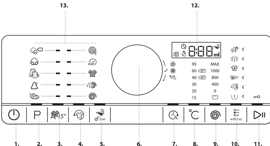
1. Ein-/Aus-Taste (bei gehaltenem Tastendruck Rücksetzung/ Abpumpen)
