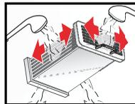
6. Flusen von den Dichtungen am Trockner und am Wärmetauscher entfernen.
