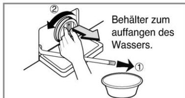
2. Öffnen Sie dann den Filter, indem Sie ihn nach links drehen.
